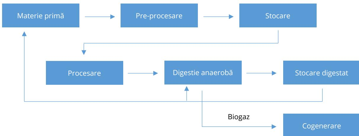
Digestia anaerobă are loc în asa numitele digestoare, care sunt bazine de stocare subterane, supraterane, orizontale sau verticale, în funcție de necesități și de situațiile existente. Gazul rezultat în urma procesului este colectat în rezervoare amplasate fie deasupra digestorului, fie independent. Cel mai utilizat tip de digestor la scară mondială este cel vertical cu acumularea biogazului deasupra rezervorului.
