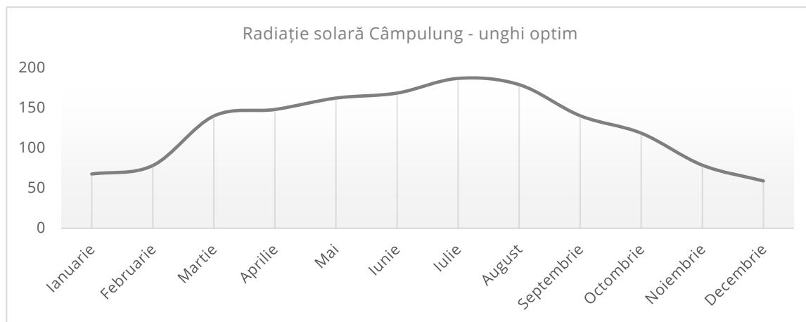
Luând în considerare unghiul optim, se obține un potențial de aproximativ  $1.525 \text{ kWh/m}^2/\text{an}$ , peste potențialul teoretic al radiației solare pe plan orizontal. Pentru evaluarea potențialului tehnic, se va lăua în considerare randamentul mediu al instalațiilor fotovoltaice de aproximativ 15%, astfel rezultând un potențial tehnic de aproximativ  $228 \text{ kWh/m}^2/\text{an}$ .
